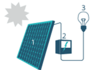
1. Zonnepaneel | 2. Omvormer | 3. Elektrische toestellen
